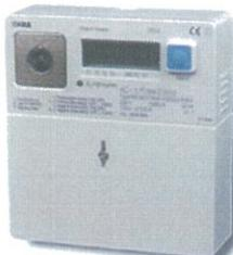
LCD дисплей счётчиков электрической энергии типа МЕ 162 представляет собой 7 сегментный экран из 8 символов. Электроэнергия отображается как число из семи цифровых цифр; первая цифра высотой 8 мм, самая левая, первое число на дисплее (высотой 5 мм) - идентифицирует код, то есть в данном случае указывает № тарифа.
