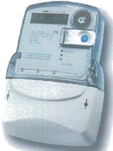
Счётчик электрической энергии типа MT174 имеет встроенные часы. Согласно требований Eesti Energia, на этих часах отображается время в соответствии с «зимним периодом», то есть без перехода на «летнее время». Часы работают на литиевой батарее и регулируют переключением тарифов. Эти установки запрограммированы согласно принятых стандартов и не меняются.
